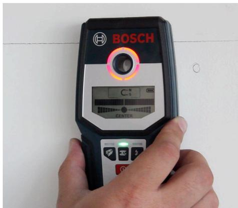
1 - Com o auxílio de um profissional especializado, localize as estruturas metálicas que sustentam as placas de drywall. Certifique-se de que as estruturas suportam o peso do suporte e TV. Marque o local onde serão fixadas as travessas de madeira.
